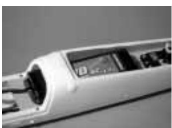
Plaats de aandrijfbatterij boven op de servoplaat zoals afgebeeld. Blokkeer de batterij door middel van piepschuim of klittenband (velcro).
