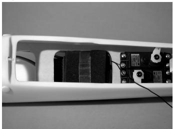
Sluit de servo's en snelheidsregelaar aan op de ontvanger en plaats de ontvanger onder de servoplaat.
