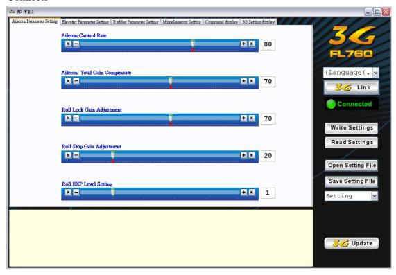
Vous pouvez cliquer sur le bouton "Write Setting" pour envoyer vos paramètres à l'unité centrale 3G. Ou cliquer sur "Read Settings" pour lire les paramètres de votre unité centrale 3G. Durant le chargement ou la lecture des paramètres l'interface est en mode "Linking Up" (Connexion).
