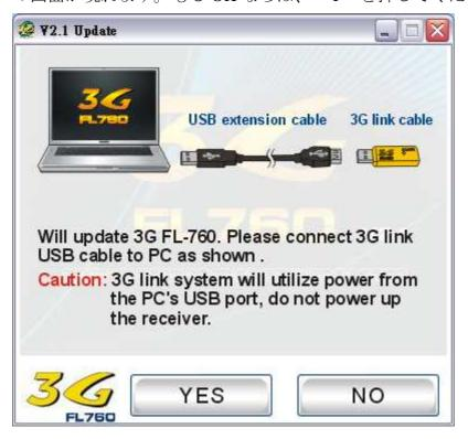
以下の図の説明と順序、Y型ケーブルによって3Gコントローラーと3Gケーブルを連接します。
