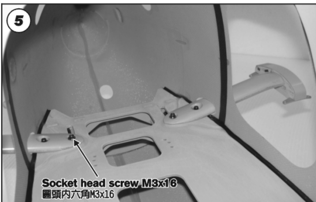
5 Mount the launching supports with socket screws T3x16 and washers \phi 3.4 \times \phi 8 \times \phi 8 \text{ mm} . 以圓頭內六角螺絲T3x16與華司 \phi 3.4 \times \phi 8 \times 0.8 \text{ mm} 分別將左、右發射器支撐架鎖附在機身固定架上。
