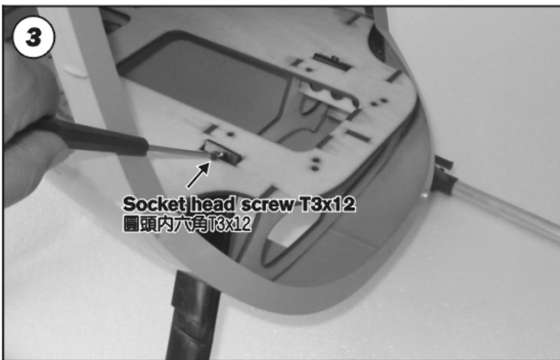
3 Fasten 4 pcs landing skids with socket head screws T3x12. 如上圖標示處，以圓頭內六角螺絲T3x12將4支腳架固定於機身固定架上。
