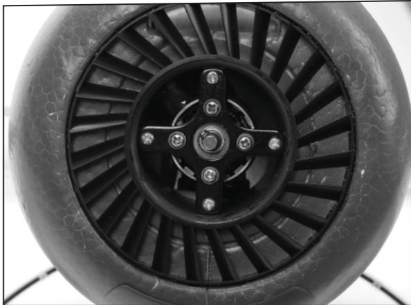
• Vue avant des vis sur le support moteur
