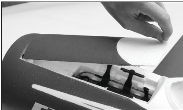
1. Retirez le capot de batterie du fuselage.
