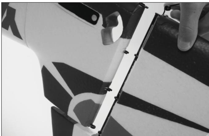
2. Placez la clavette de liaison de la gouverne de direction dans l'orifice du guignol de commande.
