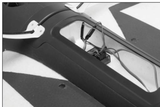
**Remarque :** les deux branchements du câble en Y sont les mêmes. Les connecteurs de servo gauche et droit peuvent être raccordés sur l'une ou l'autre des bornes du câble en Y.
