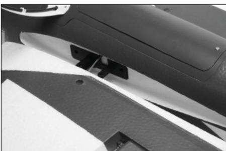
4. Fixez l'aile gauche sur le fuselage à l'aide de vis.
