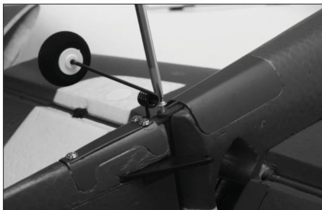
**REMARQUE :** ne serrez pas trop la vis. La gouverne de direction ne peut pas se déplacer facilement si la vis est trop serrée.
