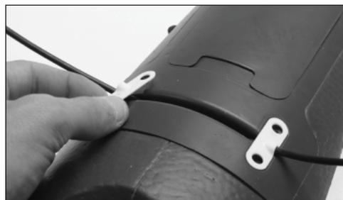
4. Installez les carénages de train d'atterrissage gauche (marqué « L ») et droit (marqué « R ») sur les supports de train et le fuselage à l'aide de 4 petites vis.
