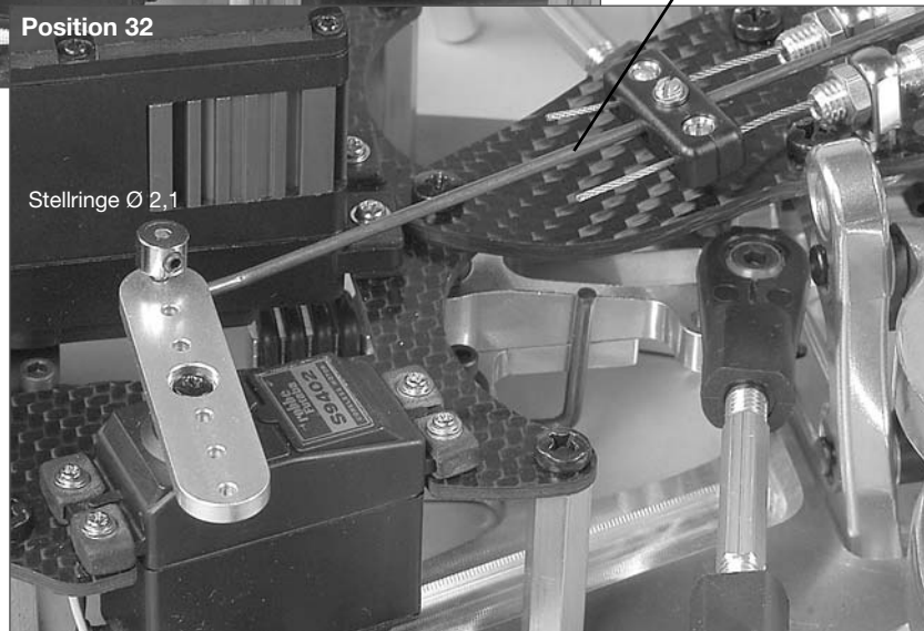
Bremsgestänge nach Abb. am Servohebel mit Stellring Ø 2,1 befestigen.
