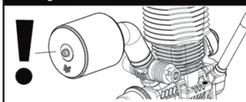
**Der Motor darf Niemals ohne Luftfilter betrieben werden. Le moteur ne doit jamais tourner sans que le filtre à air soit en place.**
