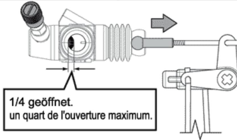
Drehe das Gasservo (bei ausgeschaltetem Empfänger) soweit, dass der Vergaser zu ca. 1/4 geöffnet ist.
