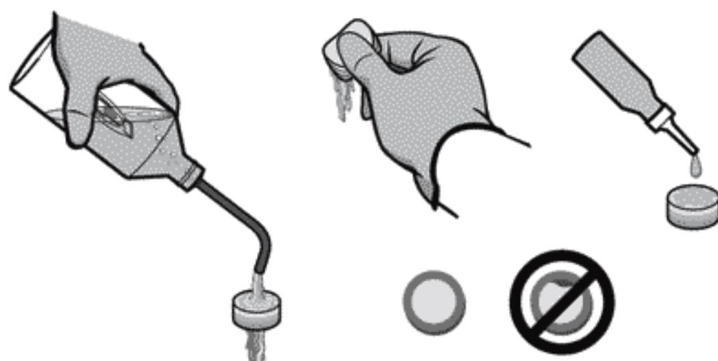
**Einbau des Luftfilters:**
