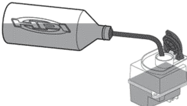
Füllen Sie den Tank komplett mit Kraftstoff. Verwenden Sie nur Kraftstoff mit 20 bis 25% Nitromethan Anteil. Verwenden Sie nur hochwertigen Kraftstoff für Modellautos. Kraftstoff der nicht speziell für Modellautos ist, kann einen Verlust der Garantie bewirken.
