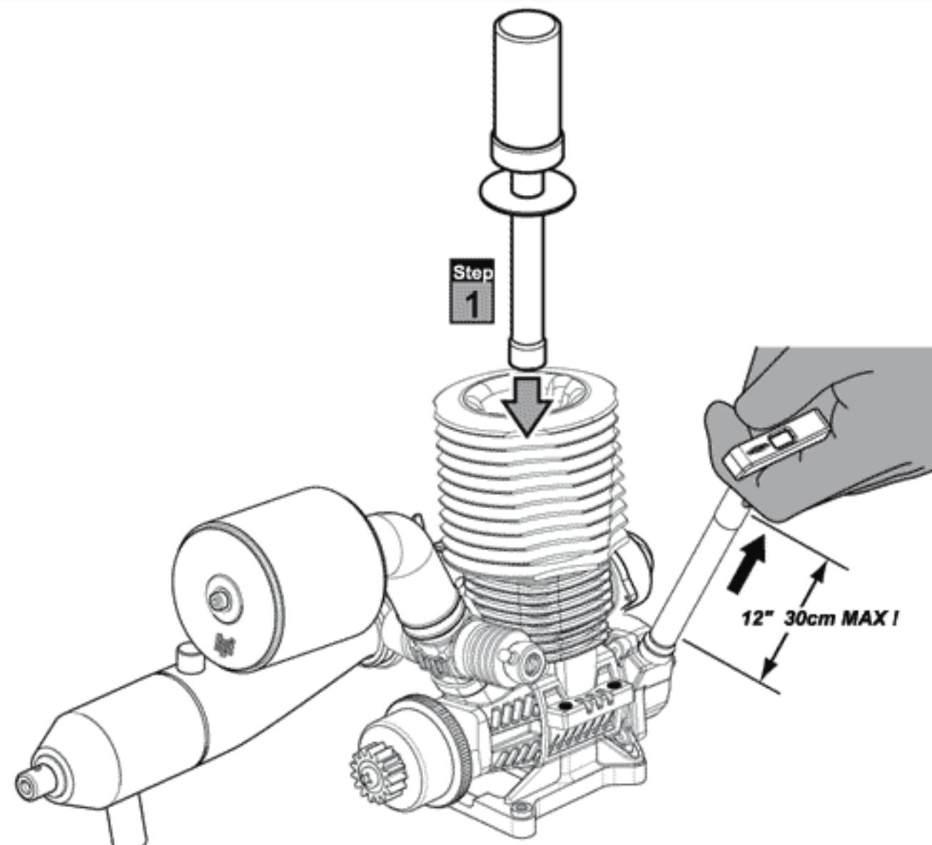
Stecken Sie den Glühkerzenstecker auf die Glühkerze. Ziehen Sie den Seilzugstarter in kurzen, schnellen Zügen. Ziehen Sie nie weiter als 30cm (12 inches). Stellen Sie das Gasservo so ein, dass der Motor ruhig im Leerlauf läuft, ohne dass die Kupplung schleift und die Räder sich drehen. Entfernen Sie den Glühkerzenstecker sobald der Motor läuft. Lassen Sie den Motor eine Tankfüllung laufen. Stoppt der Motor, wiederholen Sie die Schritte 1 bis 4.
