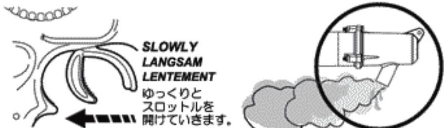
Schalten Sie den Sender und Empfänger ein. Befüllen Sie den Kraftstofftank neu und folgen Sie den Start-Schritten 1-5. Während die Reifen weiter in der Luft sind, geben Sie an der Fernsteuerung langsam Gas. Nachdem Sie Vollgas erreicht haben, gehen Sie wieder vom Gas. Damit entfernen Sie überschüssiges Öl aus dem Motor, welches sich dort durch die fetten Einstellungen ansammelt. Der Motor muß regelmäßig "freigekettet" werden, damit er nicht verfettet..
