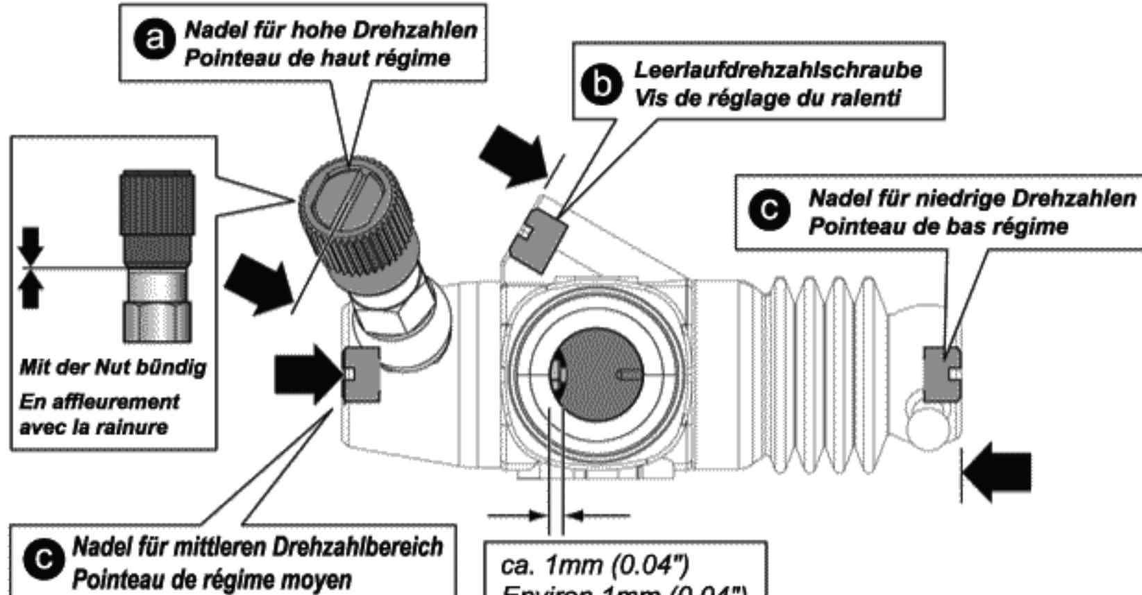
! Ne pas régler **a, b, c et d**. Les pointeaux sont pré-réglés en usine pour le rodage du moteur.
