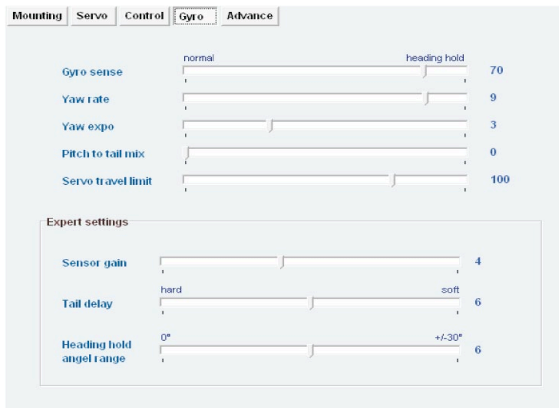
Schéma 4.1.1 / Réglages du gyroscope
