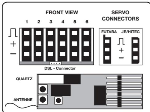
Trek de programmeerstekker uit **binnen 10-20 sec** -> De ontvanger staat in Hold modus. (de servo posities voor Fail safe worden gereset)
