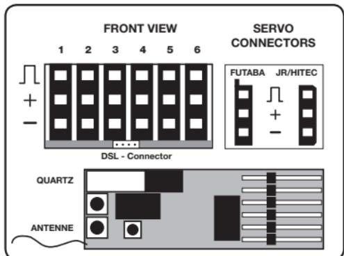
Programmierstecker abziehen innerhalb 10-20 sec -> Es wird Hold für die Störungserkennung eingestellt. (auch zum Reset von Fail Safe Positionen)
