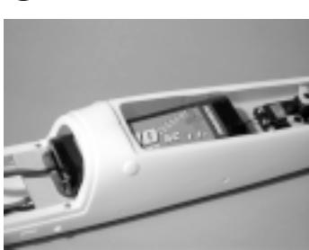
Plaats de aandrijfbatterij boven op de servoplaat zoals afgebeeld. Blokkeer de batterij door middel van piepschuim of klittenband (velcro).
