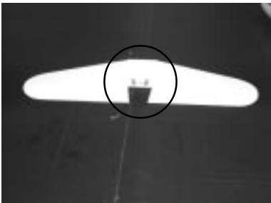
De houten pasblokjes moeten zich aan de bovenzijde bevinden als het hoogteroer in de romp geschoven wordt.
