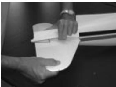
Trek de romp voorzichtig open en schuif het hoogteroer op zijn plaats, lijn het hoogteroer gelijk uit t.o.v. de romp en fixeer het hoogteroer met de houtvijsses 2x5 mm.
