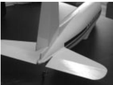
Plaats het richtingsroer in de romp en fixeer het richtingsroer met de houtvijsses 2x5 mm.
