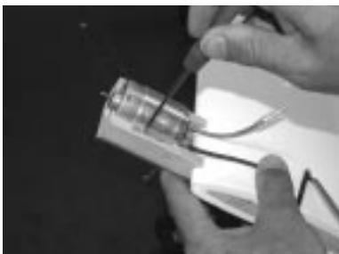
Plaats de electromotor in de motorsteun, fixeer de motor met de aluminium beugel en de 2x5mm houtvijssjes.
