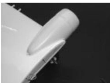
Monteer de plastiek motorgondel zoals afgebeeld. Fixeer de motorgondel met een 2x5 mm houtvijssje.
