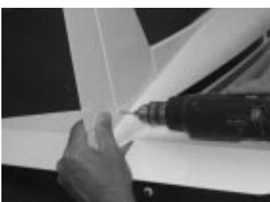
Vervolgens monteren we de roerhevels op de stuurvlakken. De gaatjes van de roerhevels moeten gelijk met de scharnierlijn van het roervlak zijn. De roerhevels worden uitgelijnd t.o.v. de stuurstang waarmee ze verbonden worden.
