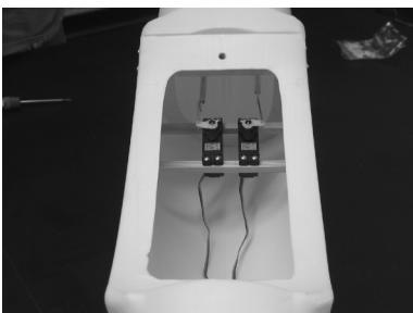
Plaats de servohouder terug in de romp en sluit de stuurstangen aan.
