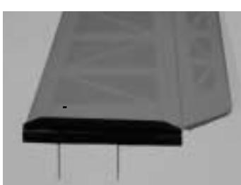
Monteer de V-vlakken op de houder en let op voor de uitlijning van de vlakken met de metalen bevestigingspennen. Breng eventueel na de montage lijm aan zodat de V-staart onveranderd blijft. Steek vervolgens de metalen pennen door de plastiek romp en borg ze aan de onderzijde met 2x M2 moeren.
