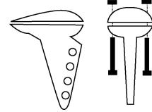
*Montieren Sie den Plastik Ruderhorn mit Hilfe der M2-Kupferschrauben und -Muttern.*
