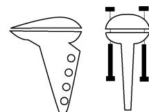
*Montieren Sie den Plastik Ruderhorn mit dem Hebel an der Unterseite mit Hilfe der M2-Kupferschrauben und -muttern auf die rechte Höhenruderfläche.*
