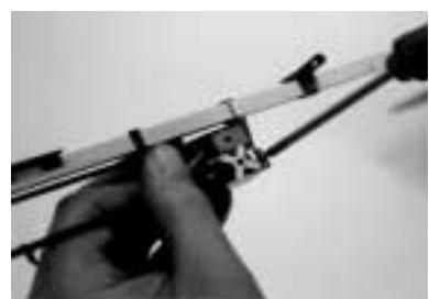
Die Empfängerstütze B6 beim Schwerpunkt auf den Rumpf des Modells leimen. Sie können das mitgelieferte doppelseitige Klebeband verwenden, um den Empfänger an der Stelle zu befestigen. Die Antenne hinten mit Klebeband befestigen. ACHTUNG: NIEMALS EINE ANTENNE VERKÜRZEN!
