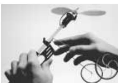
Die Plastikruderhörner in das Höhen- und Richtungssteuerwerk montieren, und diese mit den Clips verriegeln. Die Steuerstangen in die Stütze A8 schieben und die Länge der Steuerstangen anpassen. Mit einer Zange ein Z in das andere Ende des Stahldrahtes biegen. Ruderhörner und Servoarme mit dem Stahldraht befestigen.
