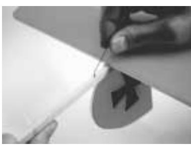
Der Schwerpunkt befindet sich 55 mm hinter der Vorderleiste des Modells. Sie können die Position des Akkus anpassen, um den Schwerpunkt zu korrigieren.
