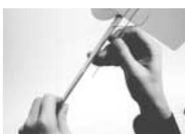
Lijm de ontvangersteun B6 in het zwaartepunt op de romp van het model. U kan gebruik maken van de meegeleverde dubbelzijdige plakband om de ontvanger op het plaatsje te bevestigen. Bevestig de antenne achteraan met plakband. **OPGEPAST: VERKORT NOOIT EEN ANTENNE!**
