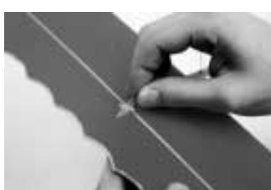
Kleef de snelheidsregelaar met dubbelzijdige tape vooraan op plasticdeel B5. Gebruik de meegeleverde elastiekjes om de vliegaccu in de opening van plasticdeel B5 te bevestigen.
