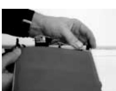
Monteer de plastic roerhoorns in het hoogte- en richtingsroer en vergrendel deze met de clips. Schuif de stuurstangen in de steun A8 en pas de lengte van de stuurstangen aan. Plooit met een tang een Z in het andere uiteinde van de staaldraad. Bevestig de roerhoorns en de servo-armen met de staaldraad. Roeruitslagen: hoogteroer +/- 10 mm naar boven/onderen. Richtingsroer: 20 tot 25 mm naar beide zijden.
