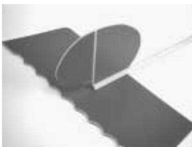
Die folgenden Plastikteile aus den Halterungen schneiden und sie in der richtigen Reihenfolge auf den Rumpf schieben: A8, B3, B4, B5 und B1. Wichtig: Die vorderen Flügelhalter (B1) 70 mm hinter die Hinterseite des Antriebs setzen.
