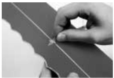
Inserrez les charnières dans les trous du stabilisateur et de la dérive et fixez les avec les arrêts. Inserrez le guignol dans le support en plastique A8 et ajustez la longueur. Coupez le surplus de guignol et faites les connections aux servos.
