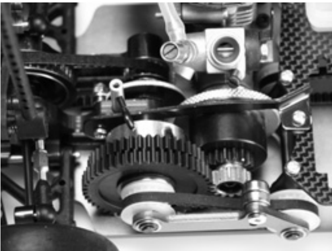
Detail of the 2-speed gear box and the tensioner Detail van de 2-versnellingsbak en de riemspanner Détail de la boîte de vitesse et du tendeur de courroie Einzelheit von Zweigang-Automatikgetriebe und von Riemenspanner
