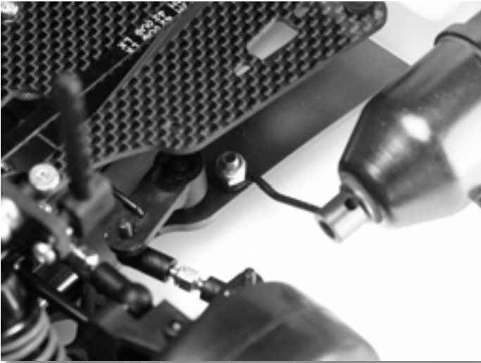
Fixing the tuned pipe on the chassis Bevestigen van de resonantieuitlaat op het chassis Fixation du résonateur sur le chassis Befestigung vom Resonanzschalldämpfer am Chassis
