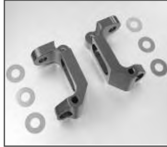
Alu-Achsschenkelhalter vorne No. 20172019 Aluminium, CNC-gefräst, eloxiert, 2 Stück
