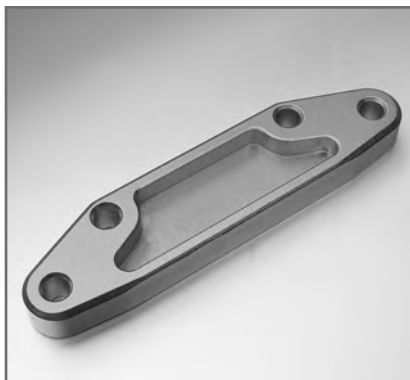
Alu-Querlenkerhalter hinten No. 20172015 Aluminium, CNC-gefräst, eloxiert, 1 Stück
