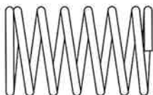
MC14 × 2 コイルスプリング Coil spring Spiralfeder Ressort hélicoïdal
