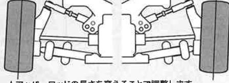
★アップバーロッドの長さを変えることで調整します。
